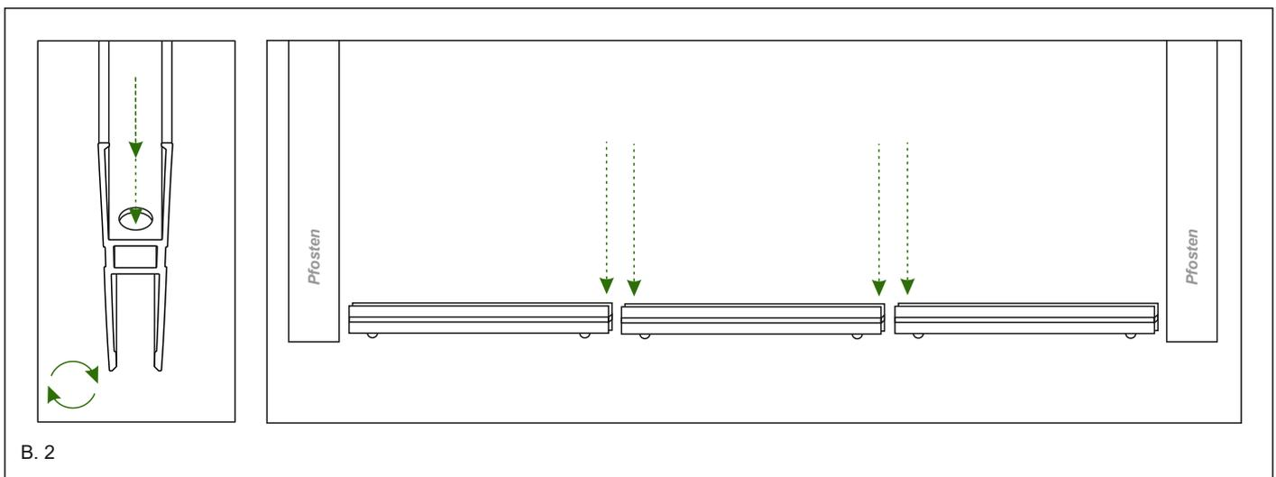
3. Setzen Sie den Einsatz von der Unterseite des H-Profiles ein. Achten Sie darauf, dass das Gewinde mit der breiteren Öffnung nach vorne zeigt.
